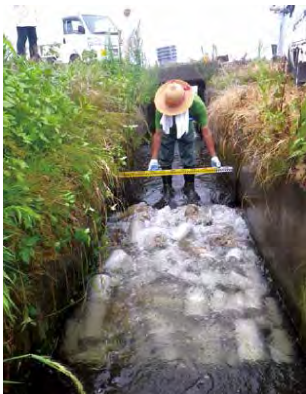
テストピース投入完了。
